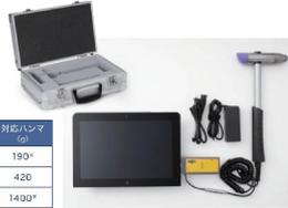
衝撃加速度計を内蔵したハンマでボルトやナットを打撃し、その時に得られる反力の時間波形によって健全性の評価を行う。
