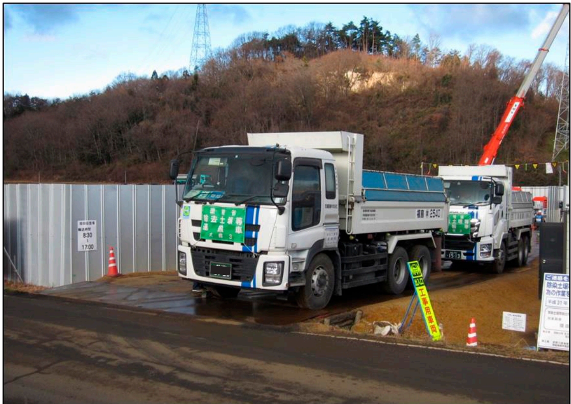
積込場に一時保管をしている除去土壌等を10tダンプトラックに積み込み、中間貯蔵施設へ輸送(国が実施)
