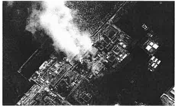
(3月14日(月)) 水素爆発を起こし、白煙状の蒸気を噴き上げている東京電力・福島第一原子力発電所3号機(中央)。建物の骨組みがむき出しになっている。左端の1号機の屋根が吹き飛ばれている様子も確認できる＝14日、米デジタルグローブ提供
