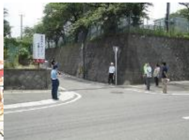
③両側が石垣になっており歩行者が見えにくいいため、カーブミラーの設置を検討
